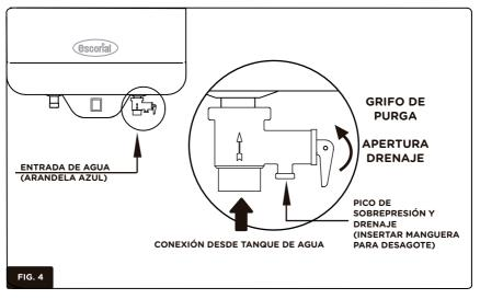
Si se genera mayor presión de la admisible dentro del termotanque, drenará agua por el pico de descarga con la válvula. Por ello se sugiere conectarle una manguera translúcida hasta la rejilla o pileta más cercana.
