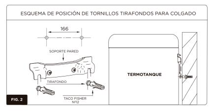
Si la mampostería no se encuentra lo suficientemente firme o los tarugos no son los adecuados, realice los ajustes pertinentes con la supervisión de personal idóneo, pues las falencias en la instalación hacen caducar la garantía. Se recuerda que no podrá instalarse en tabiquería tipo Durlok si no fueron previamente praparados para soportar este tipo de elementos
